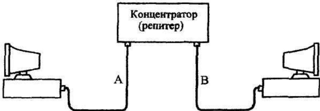
Рисунок 7 - Соединение с одним концентратором
